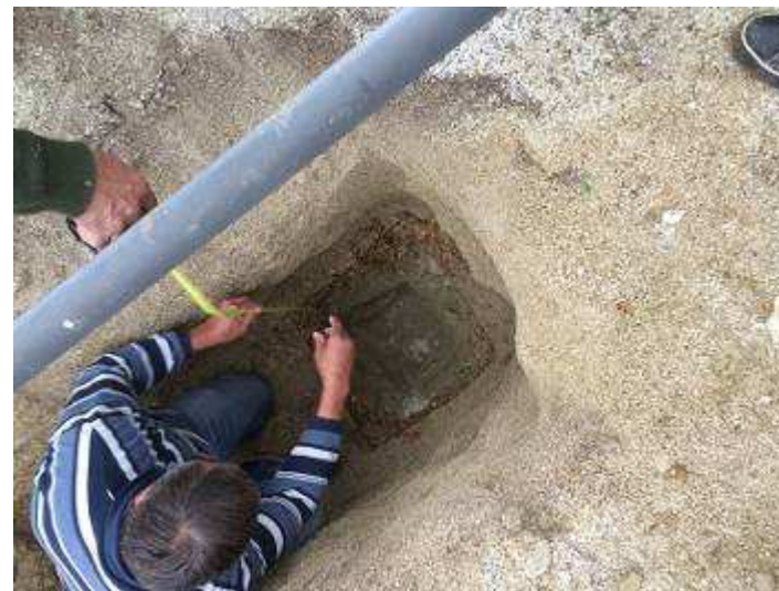
Réalisation des tests d'infiltration sur les puisarts de la STEP de Pontavert
